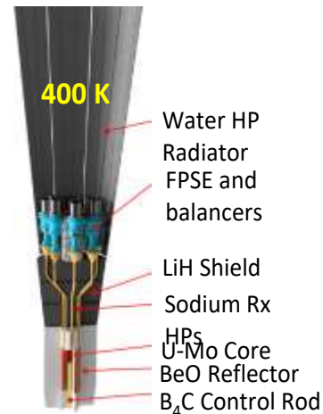
(d) NASA Kilopower Space Power System 1 kW e [Ref. 9]
